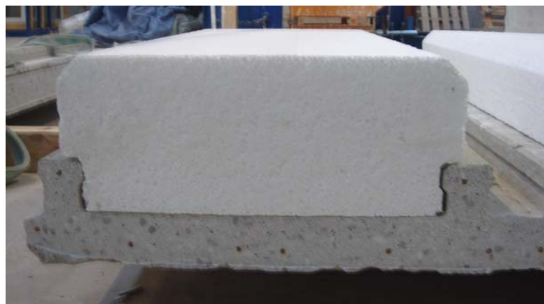
Foto 1: Sección de prelosa con bovedilla
